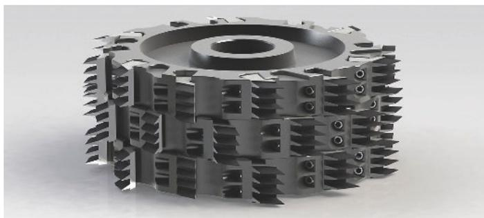
*/ Höchstleistungsausführung des Minizinkenfräasers mit bis zu zwölf Zähnen. Dank rückseitig positionierter Messerspannung bleiben die Schrauben stets sauber.*
