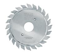
**IMPIEGO:** Lame utilizzabili in complemento alle lame sezionatrici per evitare scheggiature nella parte inferiore del materiale lavorato. Questo tipo di lama viene utilizzato su quelle macchine che non hanno la possibilità di regolare in altezza l'albero sul quale vengono montate.
